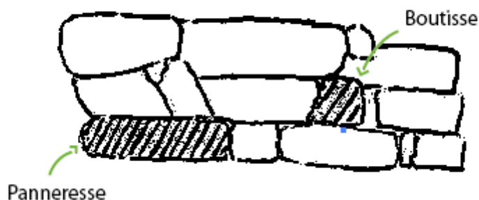
Figure 1.2 - Alternance de panneresses et boutisses au sein d'un mur en pierres sèches - Août 2018
